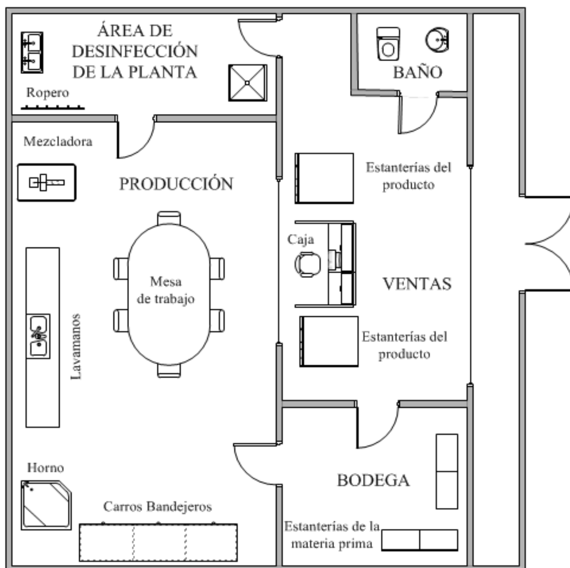
Figura 33 Plano de instalaciones
